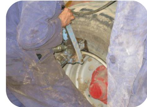
C. Mediante Destalonador
