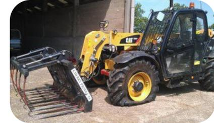
Una mala presión de los neumáticos es peligrosa y puede causar fallos en la llanta!
