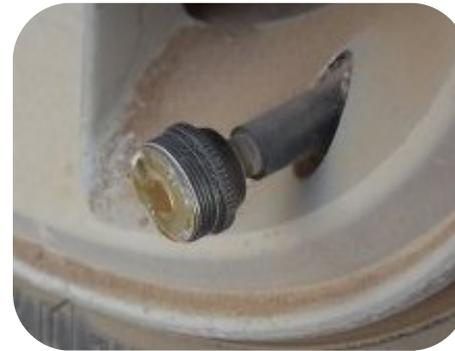
p.ex. capteurs externes ou des capteurs dans les bouchons de valve :
