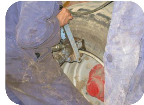
C. Détalonneur pneus
